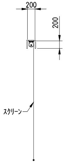
上部マスク寸法は内部リミットスイッチにて調整可能 (0~400)
